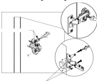
Дверцы регулируются тремя винтами, отвечающими соответственно за высоту, глубину и наклон.
